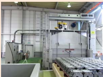
大型熱処理炉
