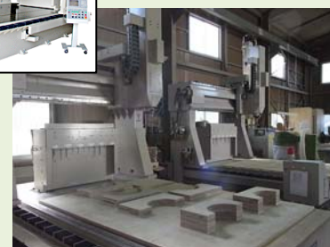
NC 加工機による木型製作
